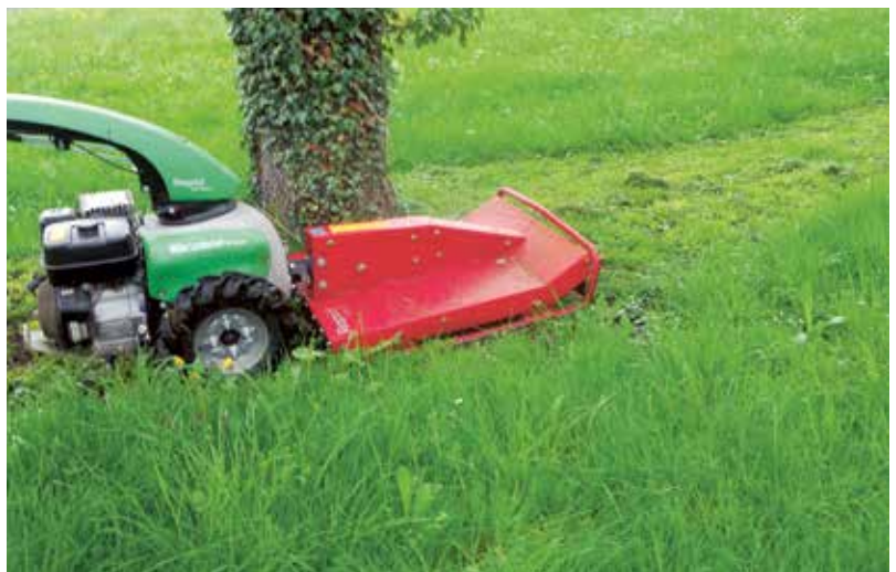
Zum Mulchen der Baumscheiben eignen sich am besten gut lenkbare Kleinmulchgeräte, die keine Schäden an den Bäumen verursachen.
