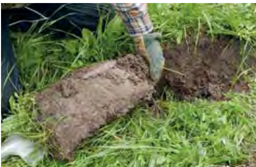
Die Spatenprobe ist die einfachste und schnellste Methode zur Beurteilung der Bodeneignung.
