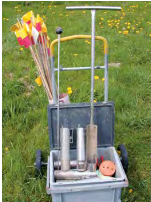
Das übliche topcat-Set besteht aus einem Suchstab, dem Lochschneider, Markierstäben und einem Dutzend Fallen.
