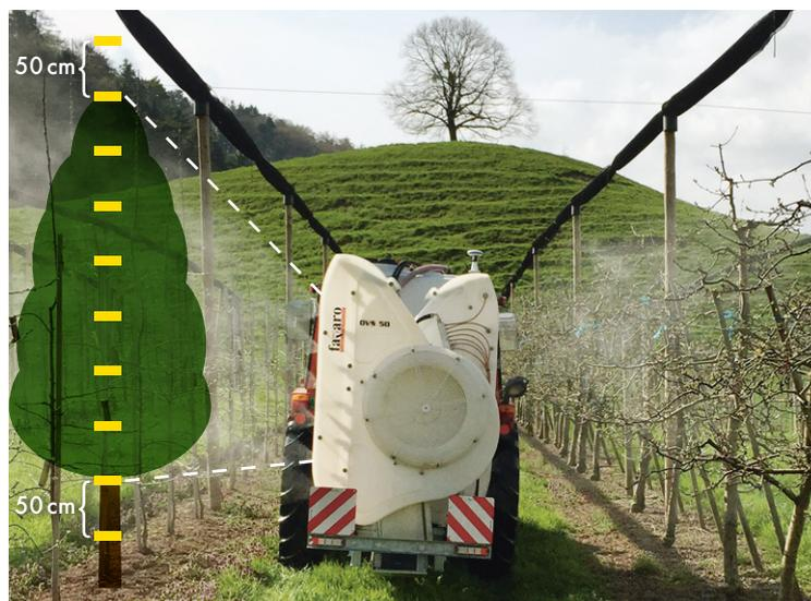
Die optimale Lenkung des Luftstroms und der Benetzungsgrad können mittels wasserempfindlichen Papieren in, über und unter der Baumkrone verifiziert werden.
