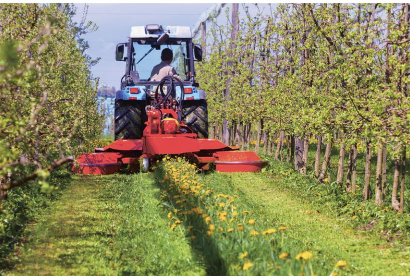
Die für die Pflege von Blühstreifen angepassten Mulchgeräte (im Bild das Modell «Humus OMB®» mit Seitenauswurf) ermöglichen eine effiziente Pflege der Fahrgassen bei gleichzeitiger Schonung der Blühstreifenpflanzen.
